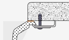
Pour le montage sous-plan d'éviers encastrables, il convient de faire appel à des éléments de fixation spéciaux.
