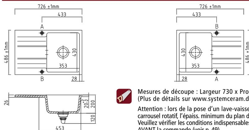
**Mesures de découpe :** Largeur 730 x Profondeur 490 mm (Plus de détails sur [www.systemceram.de](http://www.systemceram.de))
