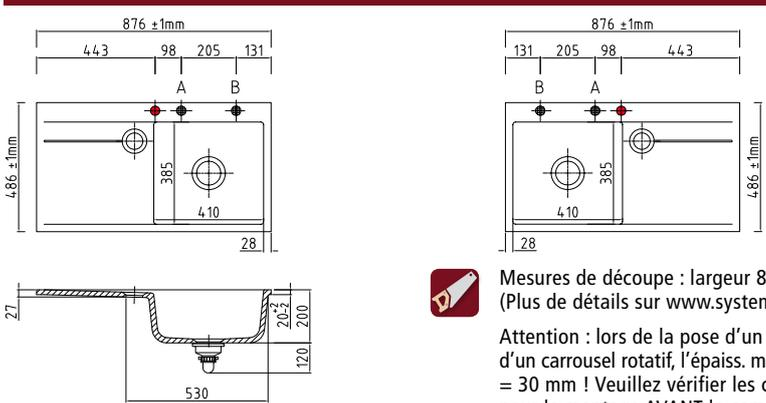
Mesures de découpe : largeur 880 x profondeur 490 mm (Plus de détails sur [www.systemceram.de](http://www.systemceram.de))
