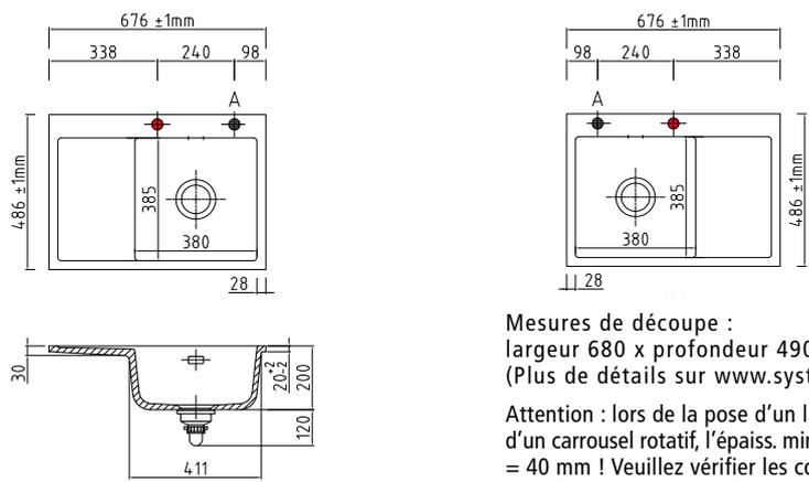
Mesures de découpe : largeur 680 x profondeur 490 mm (Plus de détails sur [www.systemceram.de](http://www.systemceram.de))
