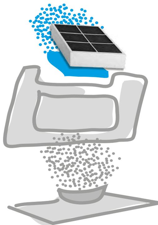
Grâce au filtre plasma **aira® PLANO**, une multitude d'autres applications sont couvertes dans le domaine professionnel. Comme les autres filtres plasma d'AVITANA, le filtre est facile et rapide à monter et peut être installé ultérieurement sur les hottes aspirantes existantes, afin que rien ne s'oppose à l'air frais.
