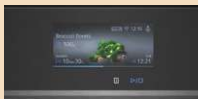
TFT-Touchdisplay Plus 96 mm x 42 mm
