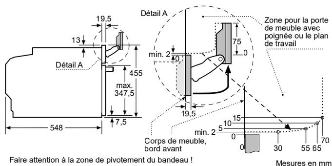
Si l'appareil compact est installé sous une table de cuisson, les épaisseurs de plaque de travail suivantes (le cas échéant y compris la sous-structure) doivent être respectées.
